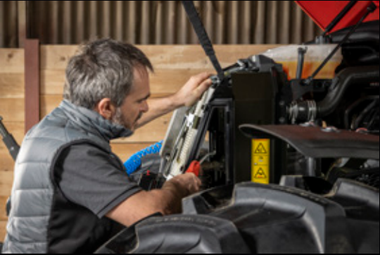
Il gruppo dei radiatori è facilmente accessibile per rendere la pulizia più comoda e veloce.
