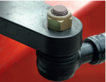
▲ Testa dei tiranti dello sterzo regolabile
